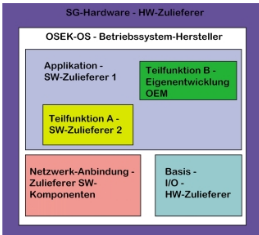
Bild 1: Beispiel für die Software-Architektur eines Steuergeräts bei dem verschiedene Entwicklungspartner Teile der Software beistellen
